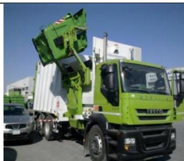
Contêineres para sistema de coleta automatizada multiseletiva, disponibilizados na via pública e de uso coletivo. Operado com caminhão de carregamento bilateral robotizado, que não requer garis coletores:
