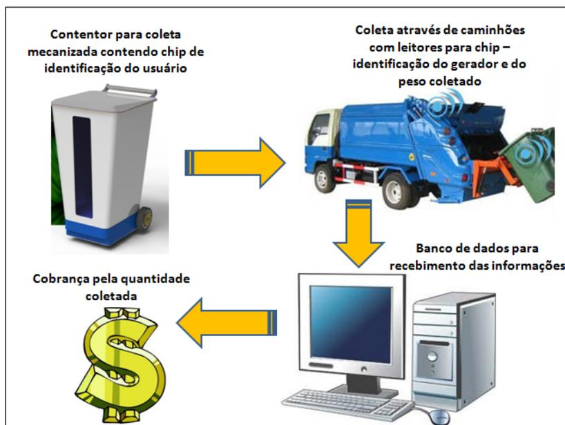
Figura 36: Sistemas de pesagem de resíduos através de mecanismos acoplados aos contentores e caminhões de coleta.
