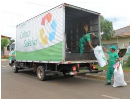
Figura 5: Caminhão com carroceria baú com carregamento manual (Xanxerê –SC).
