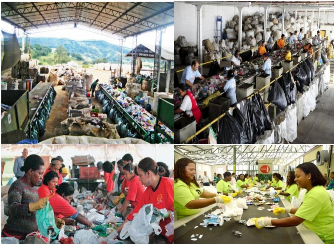
Figura 18: Unidades de triagem no sistema semi-mecanizado.
