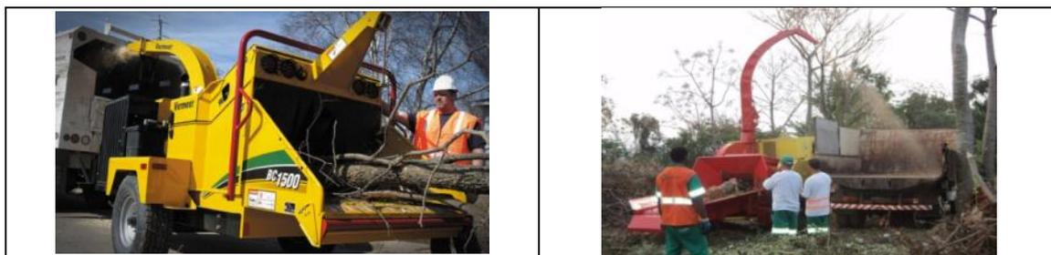
Figura 30: modelos de picadores de grande porte: móvel e fixo.
