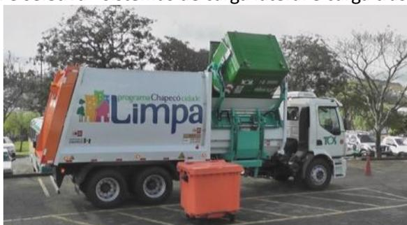
Figura 2: Equipamentos para coleta conteneirizada e automatizada
