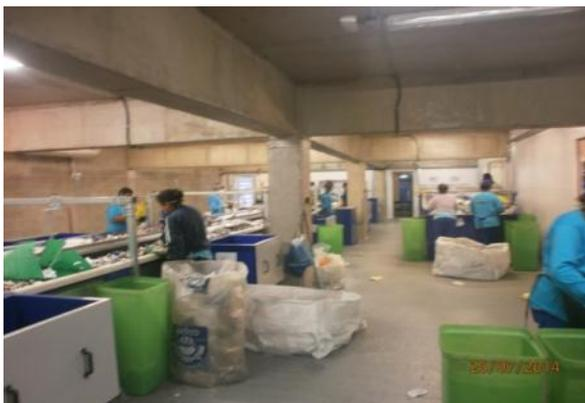
Figura 19: Central de triagem totalmente mecanizada em São Paulo, onde os triadores atuam no final do processo, nos controles de qualidade.
