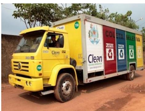
Figura 3: Caminhão com carroceria baú com carregamento manual (Parauapebas-PA)
