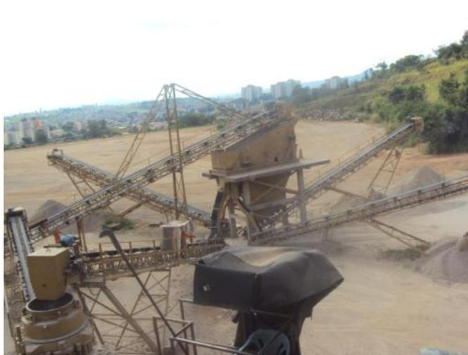
Figura 31- Unidade de reciclagem de RCD de Belo Horizonte.
